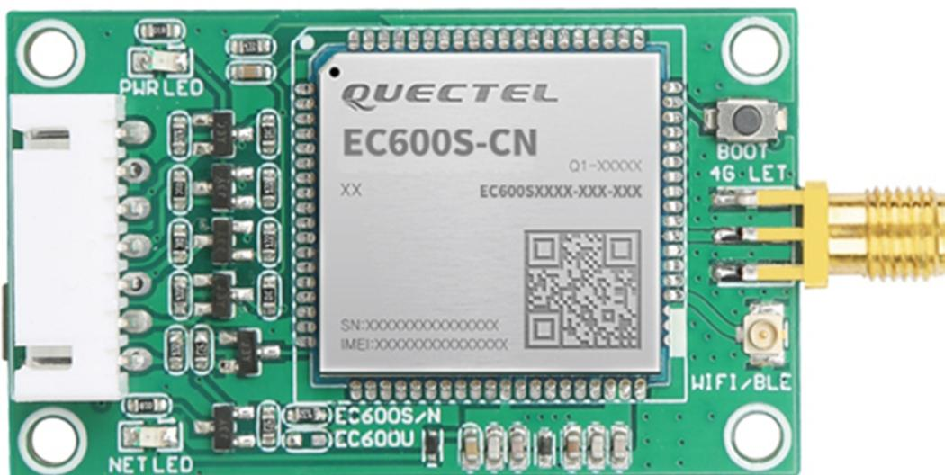
Core-EC600 核心板是由银尔达 (yinerda) 基于移远 EC600S/N/U 三款模组推出的低功耗, 小体积, 高性能嵌入式 4G Cat1 核心版, 硬件尺寸完全兼容本公司的 Core-Air724/Core-N58 核心板, 最小成本的进行 2G、4G 切换, 主要特点如下:
