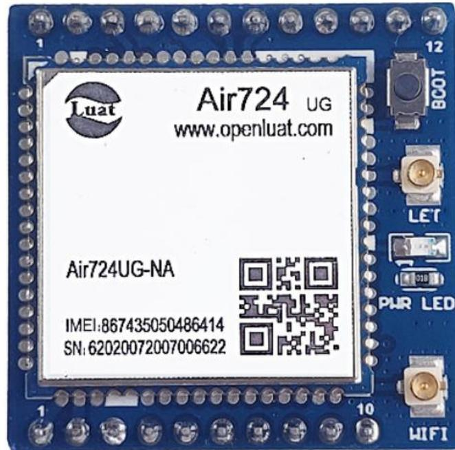
YED-C724 核心板是由银尔达 (yinerda) 基于合宙 Air724 模组推出的低功耗, 超小体积, 高性能嵌入式 4G Cat1 核心版, 标准的 2.54 排针、最小成本的进项 2G、4G Cat4 切换; 主要功能如下:
